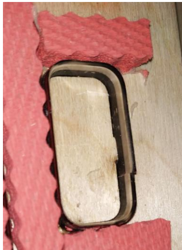
Ножи разошлись на горизонтальном стыке
