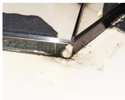
Сварка углового сопряжения ножей
