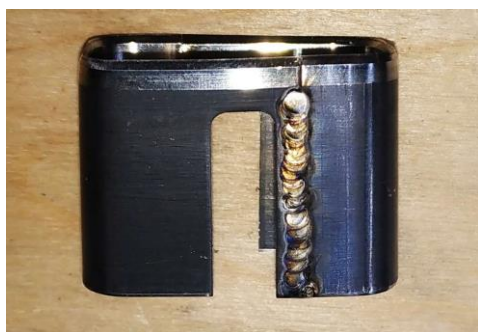
Сварка ножей «в стык»
